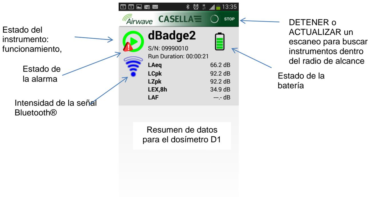
Para ahorrar energía, la aplicación Airwave detiene el escaneo una vez detectados todos los instrumentos dentro del radio de alcance. Para buscar nuevos instrumentos, pulse ACTUALIZAR en la parte superior derecha de la pantalla del dispositivo móvil.
