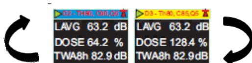
D1 es el dosímetro principal, que informa de los valores de la dosis seleccionada y de otros parámetros de ruido (pico, máx. etc.) D2 y D3 ofrecen funciones adicionales. La barra del encabezado para las mediciones de D1 es del color de la pantalla de fondo. El D2 tiene la barra del encabezado azul y la del D3 es amarilla.
