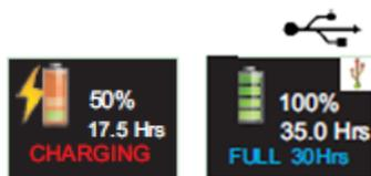
El tiempo de carga completa de una batería completamente agotada es de aproximadamente 6 horas, generando un tiempo de funcionamiento de unas 35 horas. Recuerde que esto se corresponde a un uso sin análisis de banda de octava y si la pantalla está apagada durante el 95 % del tiempo.
