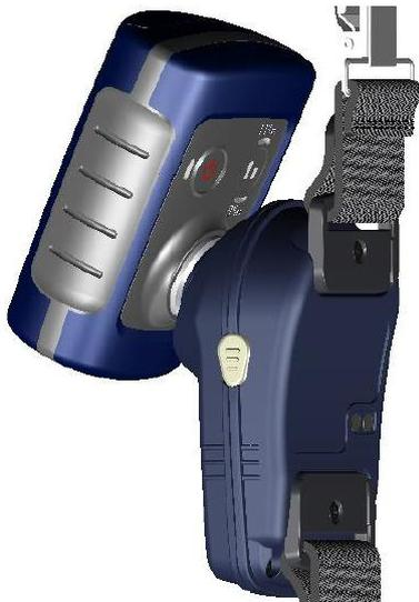
**Nota:** el dosímetro no accederá al modo de calibración si está ejecutándose un proceso de medición. Si hay un proceso en marcha, detenga la medición según lo indicado en el apartado 6.5.
