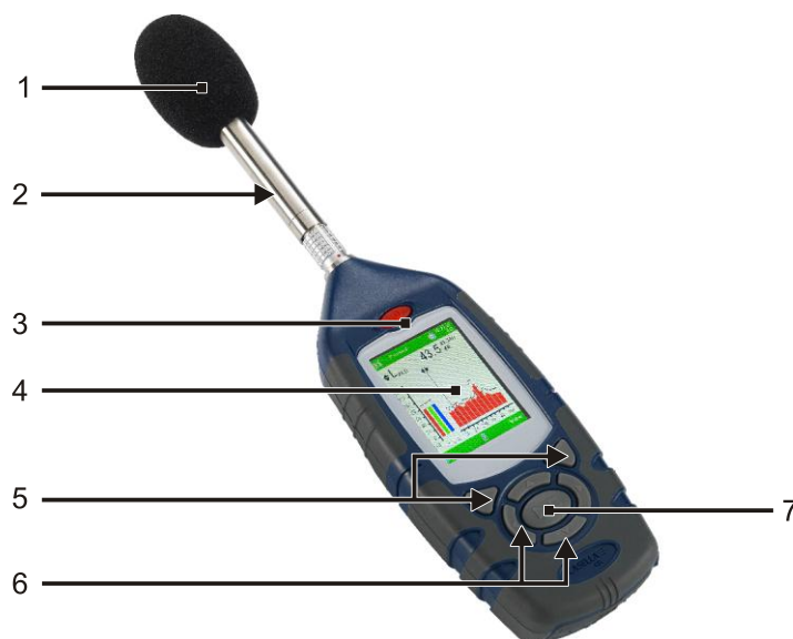
Abbildung 1. Hauptmerkmale des CEL-63x-Schallpegelmessers
