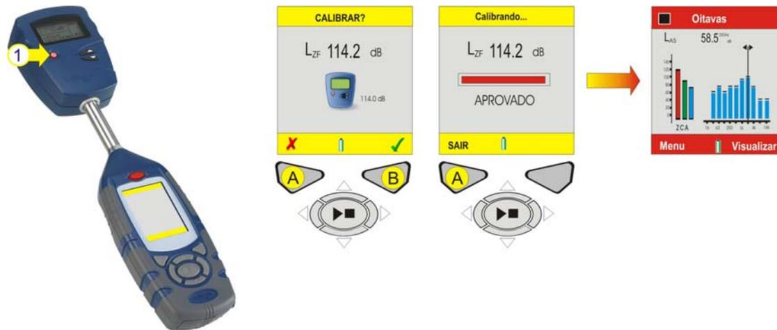
Figura 15 Calibragem do Instrumento
