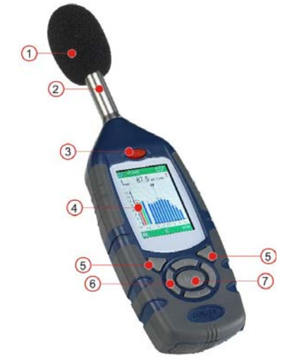
Figura 1 CEL Série 6X0 1 – Protetor contra vento (Cobrindo microfone removível) 2 – Amplificador Fixo 3 – Botão Interruptor 4 – Visor 5 – Teclas Programáveis 6 – Teclas do Cursor de Navegação 7 – Tecla de Iniciar/Parar
